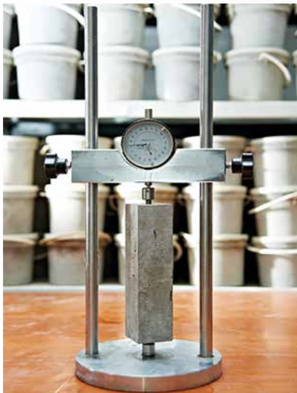
Рис. 2. Устройство для определения деформаций усадки (расширения)
