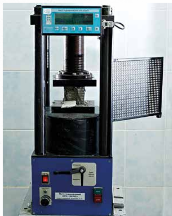
Рис. 1. Пресс гидравлический для определения прочности
